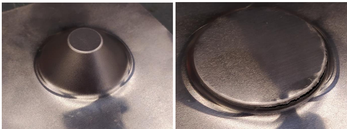
19. ábra: Első alakítási kísérlet eredménye (balra) és a 6. sorszámú kísérlet eredménye (jobbra, nagyított kép)
