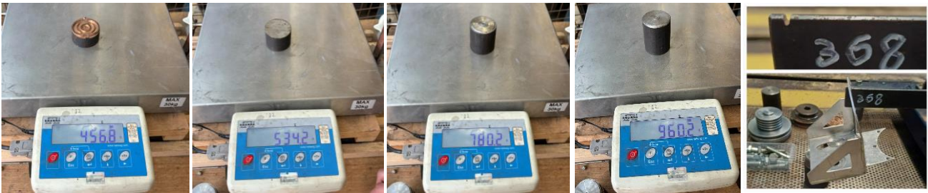
5-2. ábra Erőmérő cella kalibráló súlyok és kalibrációs elrendezés (saját szerkesztés)
