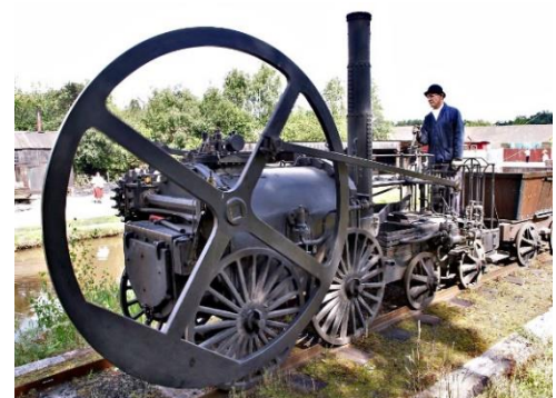
2-3. ábra Lendkerék egy Trevithick 1802-es gőzmozdonyon [15]
