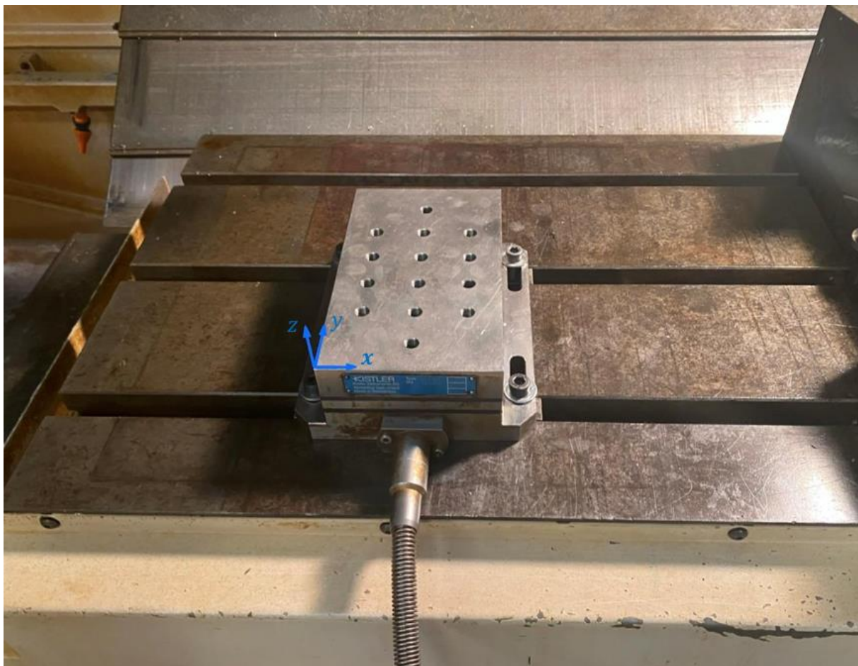
7. Ábra. Kistler 9257B piezoelektromos erőmérő szenzor.
