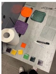
7.1 és 7.2 Kép Polimer masszából megszilárdulás után egy négyzet alapú próba minta kivágása.
