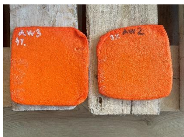
7.1 és 7.2 Kép Polimer masszából megszilárdulás után egy négyzet alapú próba minta kivágása.
