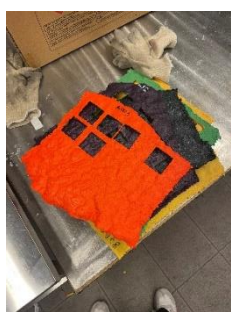
7.1 és 7.2 Kép Polimer masszából megszilárdulás után egy négyzet alapú próba minta kivágása.
