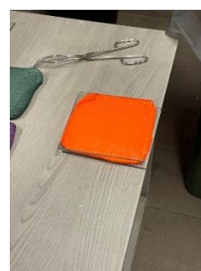
7.3 Kép A mintadarabot két hideg üveglap közé szorítjuk.
