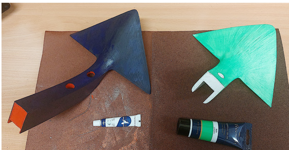
19. ábra. 3D nyomtatott szerszámok csiszolás és festés után. a) Piros szerszám, b) fehér szerszám.
