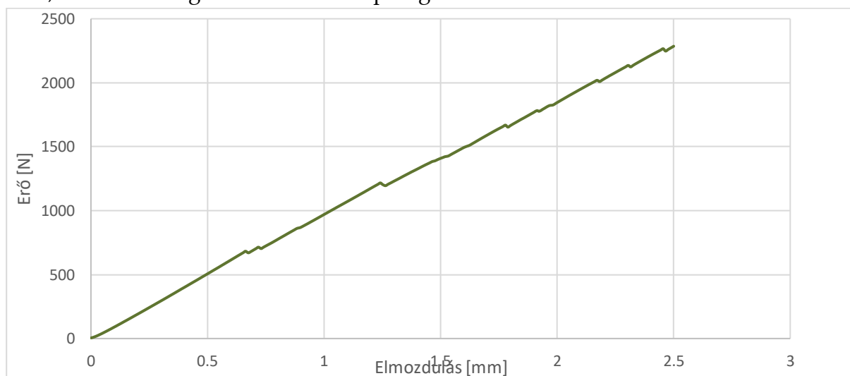
4.6. Ábra Impregnált roving szakítás jellemző szakítógörbéje
