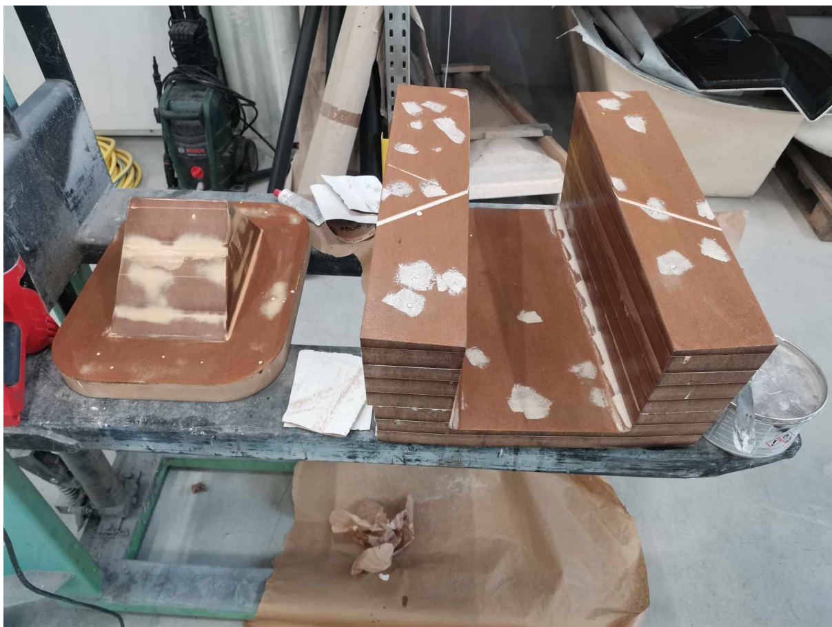
39. ábra Motorkiemelő rendszer takaró szoknya ősminta szerszáma egyik nézet
