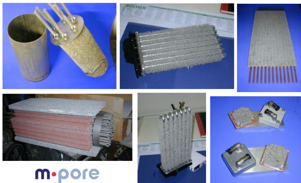
2.6. ábra. Különböző hőcserélő konstrukciók az M-pore és a Mayser GmbH jóvoltából [7].
