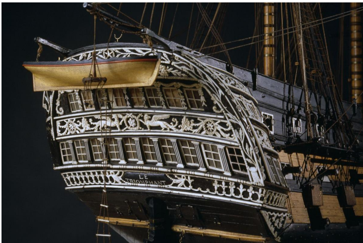
A Triomphant makettjének tatja. A maketteken még megengedhető volt, hogy amit a valódi hajókon utólag fehérre festett fából faragtak, az itt elefántcsontból készüljön. (90)
