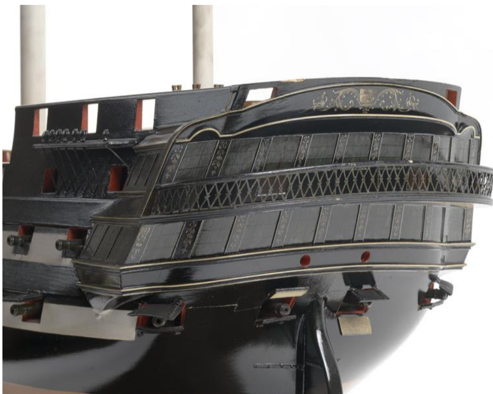
Az 1835-ös Vanguard már az elliptikus tattal rendelkezik. A kialakítás az 1830-as években terjedt el és olyan jól bevált, hogy az utolsó angol vitorlás sorhajókon is ezt használták. (86)
