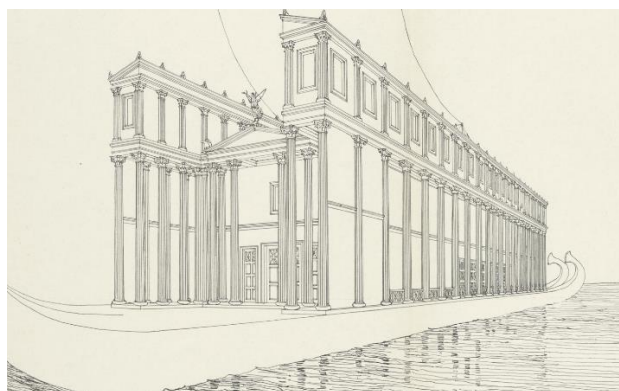
Főhomlokzat és látvány Caspari rajzain. (6,7) Az oszlopok meglehetősen vékonyak, és két szintet is összekötnék. A kissé feszes, szokatlan arányú oszloprend méreteire Caspari valószínűleg az fa anyagából következtetett.
