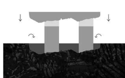
födémlemez visszahelyezése, földbevájt zsalu visszatemetése
