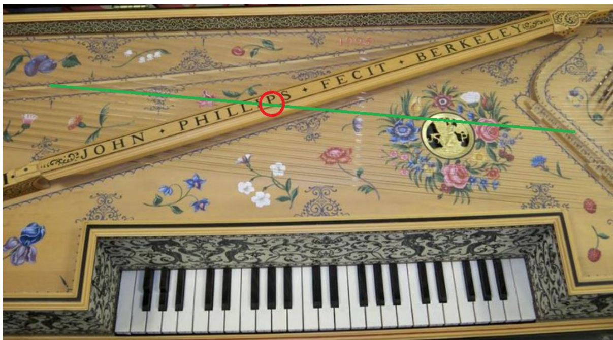
5. ábra. Ruckers család által készített muselar típusú virginal. Zöld egyenes: húr rezgő hossza; piros karika: lécs alatt található a húrhoz tartozó pengető. Látható, hogy a pengetési arány közel 1/2
