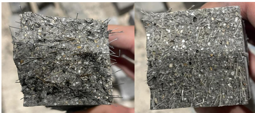
23. ábra: Szálak alakulása a próbatest tönkremenetelkor (Bal oldal: acél szálak keverék; jobb oldal: műanyag szálak keverék)
