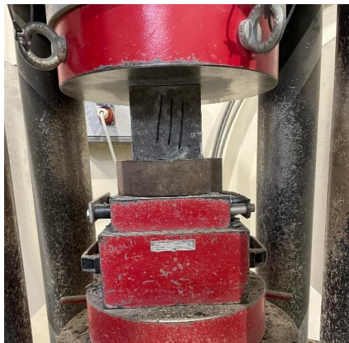
8. ábra: Nyomószilárdsági vizsgálat 100×100×100 mm-es próbatesten
