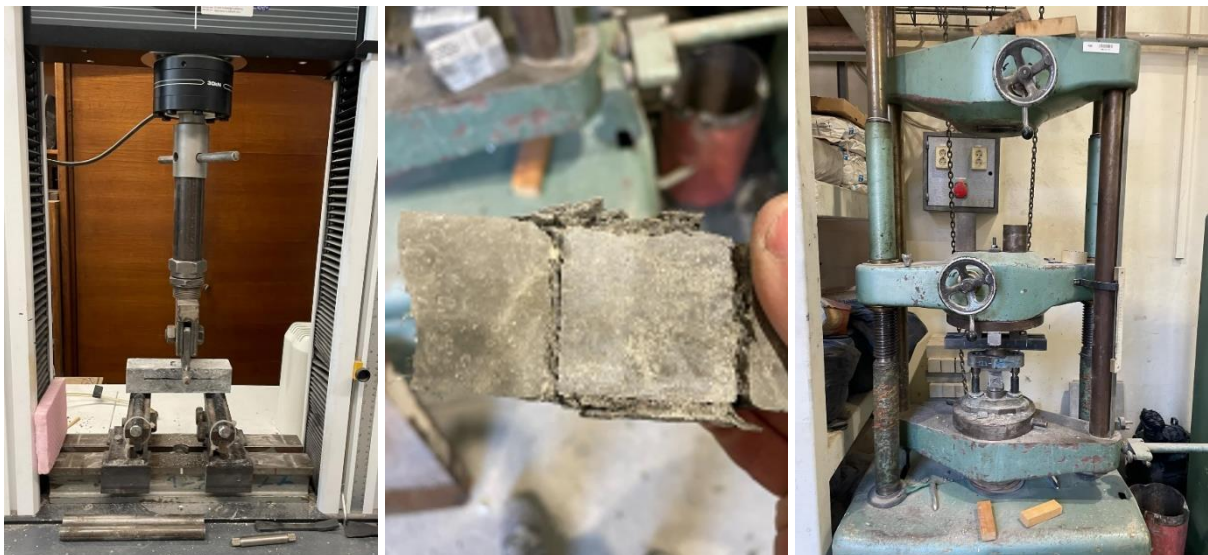
10. ábra: Hajlító-húzószilárdság vizsgálat 40×40×160 mm-es próbatesten
