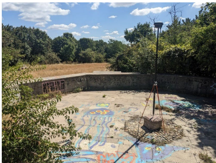
2.3. ábra: A kissvábhegyi háromszögelési alappont, és az általunk használt Leica GS18i GNSS vevő
