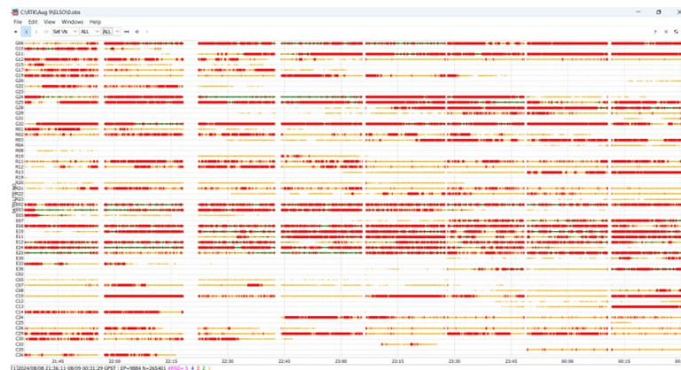
3.2. ábra: A 8 mérés adatai összefűzve, az egyes műholdak láthatósága. A ciklusugrásokat vastag piros vonal jelzi.
