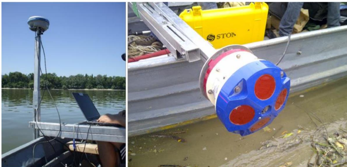
8. ábra: ADCP műszer (jobbra) és a műszer működés közben, RTK-GPS-szel a mért függély tengelyében.
