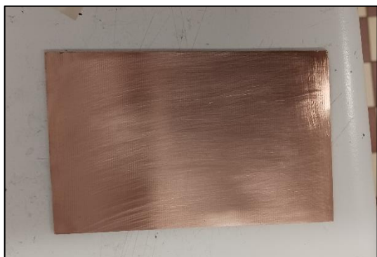
5. kép Az egyoldali üres NYÁK vágás, csiszolás és tisztítás után
