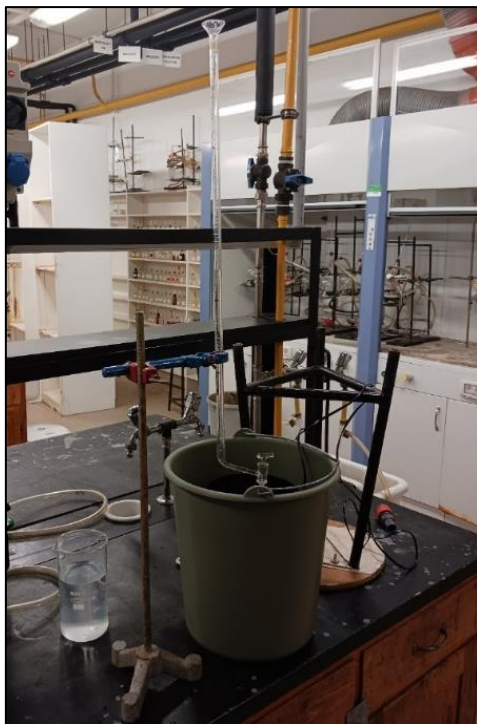
12. kép A billenőedényes mérőeszköz kalibrálása
