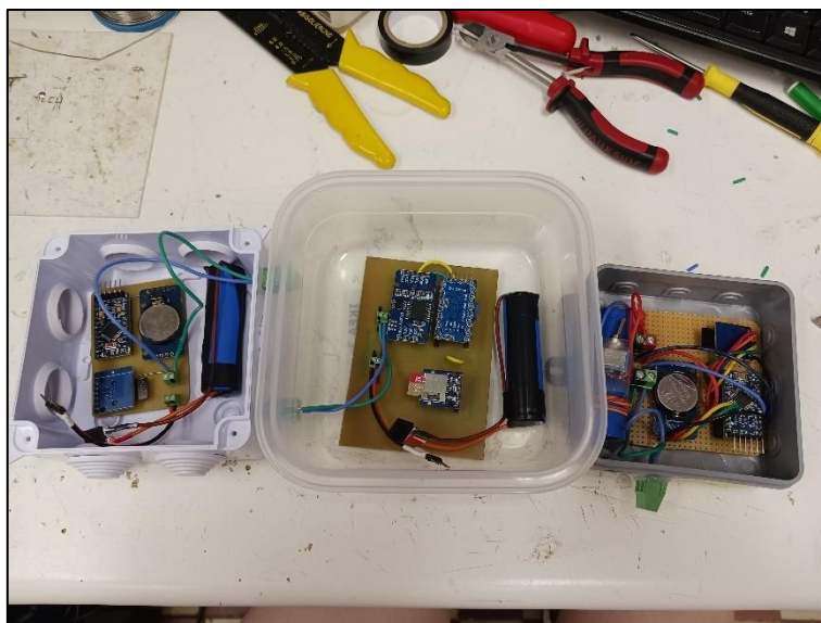
11. kép A Vass Imre-barlang kész mérőeszközeinek hardware részei
