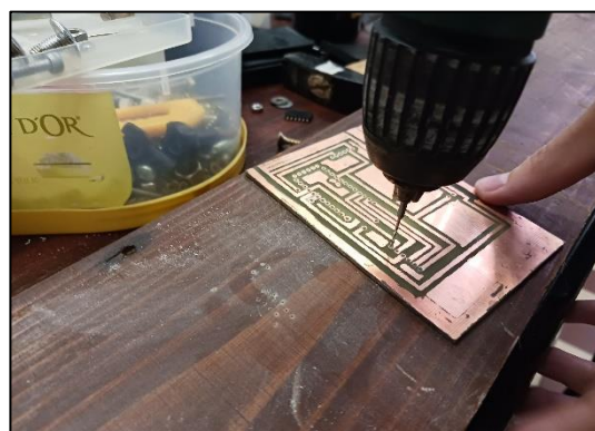
8. kép Lyukak fúrása a modulok lábaihoz
