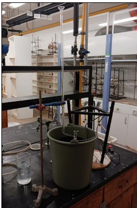
12. kép A billenőedényes mérőeszköz kalibrálása
