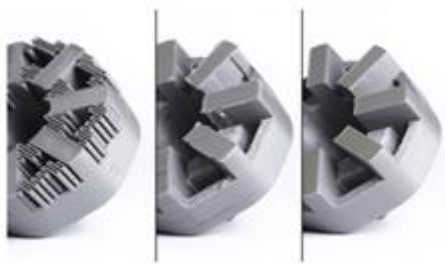
8. ábra A képen a tisztítás folyamatai láthatóak
