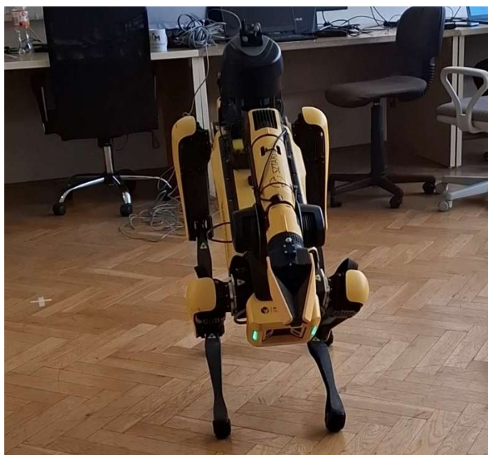
42. ábra: Kép a helymeghatározó eszközökkel ellátott robotkutyáról
