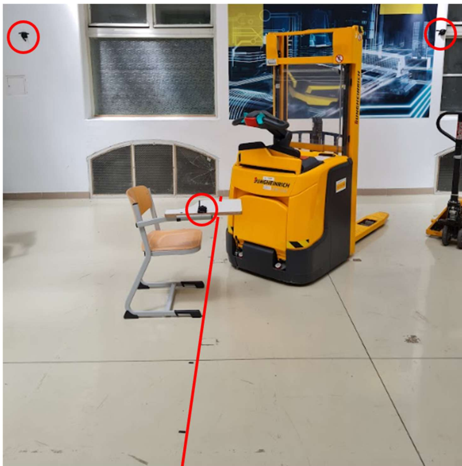
24. ábra: Falra helyezett jeladókkal való mérés akadállyal
