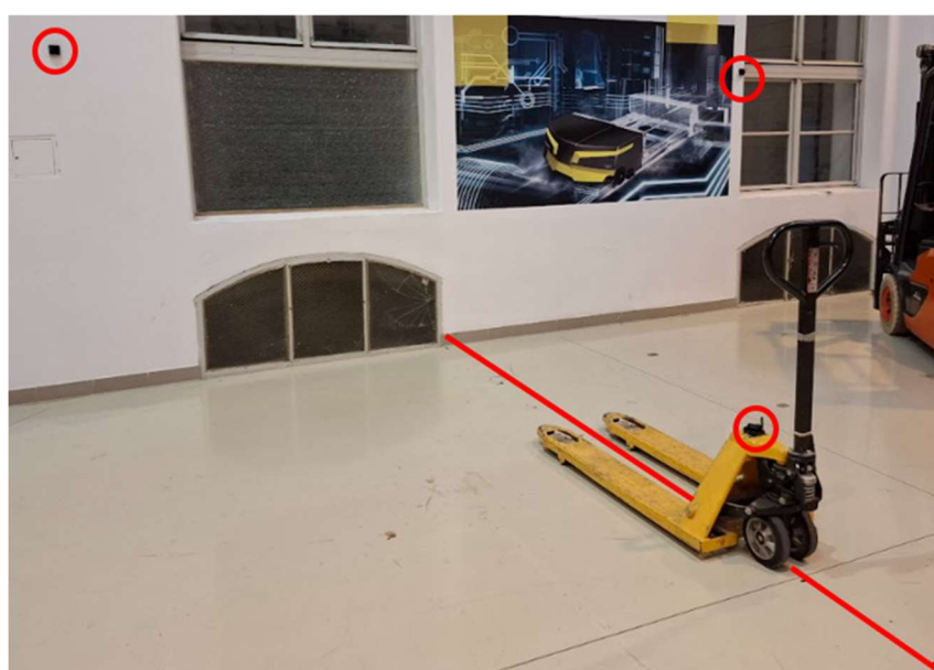
22. ábra: Falra helyezett jeladókkal való mérés
