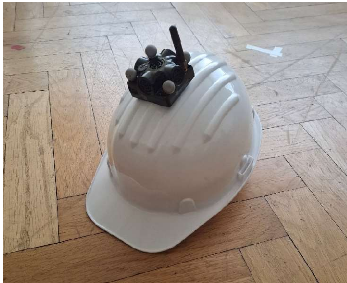
43. ábra: Kép egy helymeghatározó eszközökkel ellátott sisakról
