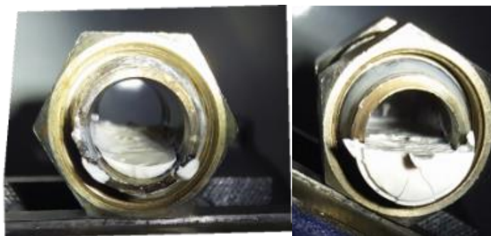
21. ábra A reaktorban maradt polimer a belépési (balra), illetve a kilépési (jobbra) végről fotózva
