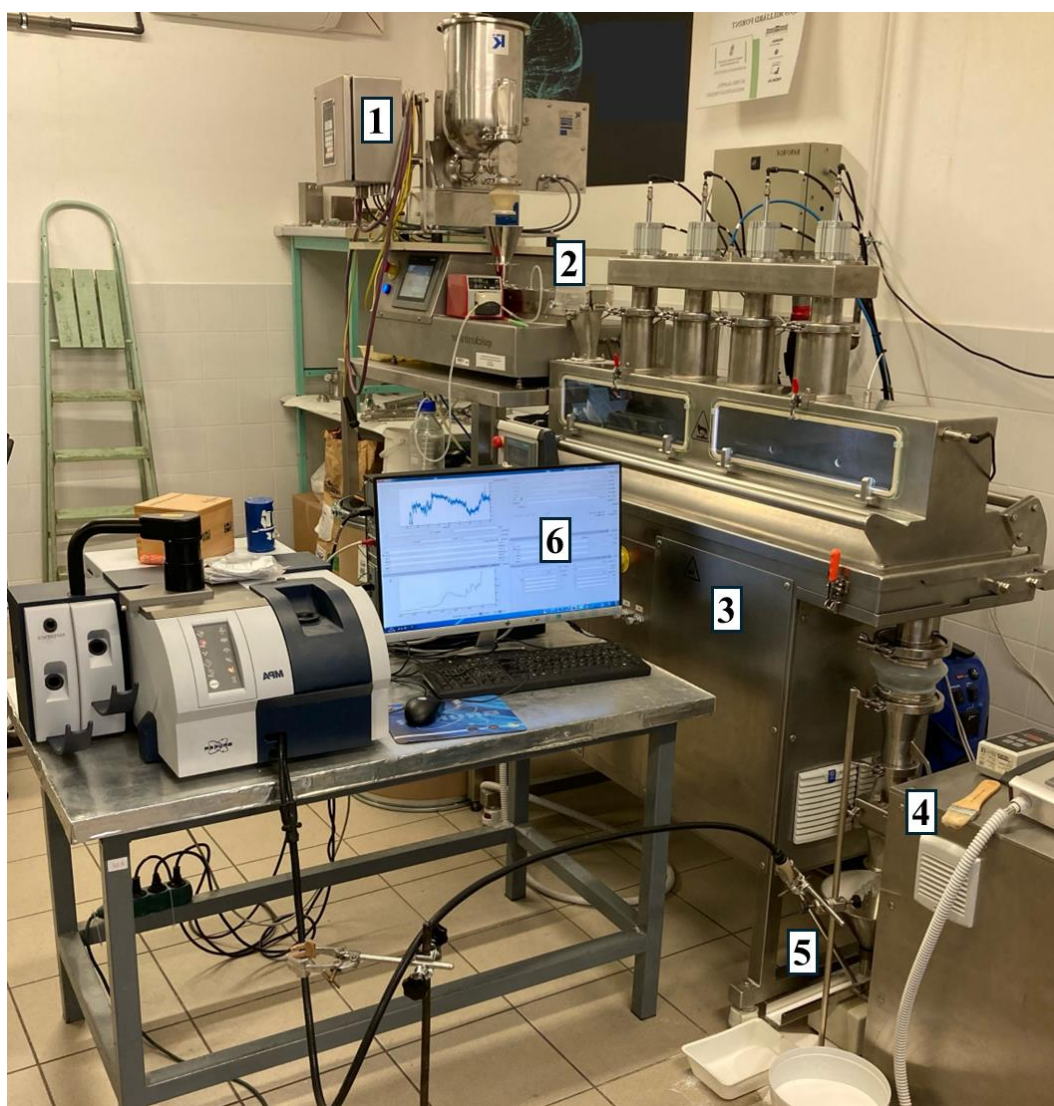
8. ábra: Az integrált, folyamatos gyártósor: (1) gravimetrikus adagoló, (2) ikercsigás granuláló, (3) folyamatos szárítóberendezés, (4) oszcillációs őrlő, (5) NIR szonda, (6) számítógép a valós idejű, in-line nyomon követéshez
