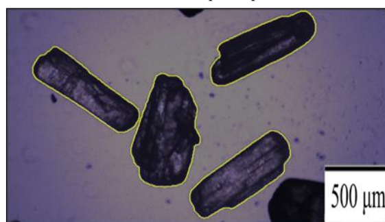
22. ábra. A 300\text{-}500\ \mu\text{m} névleges szemcseméretű ASA frakció Roboflow-val bejelölt szemcséiről készült mikroszkópos kép.
