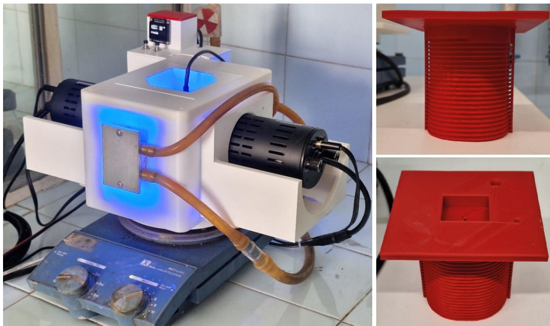
49. ábra A 3D nyomtatott fotoreaktor működés közben (balra), Az áramlásos kémia feltét (jobbra)
