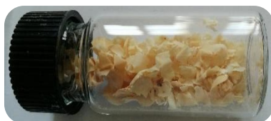
18. ábra 300 °C-on elszíneződött epoxi gyanta
