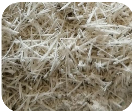
29. ábra A darált, kezeletlen szélerőműlapát
