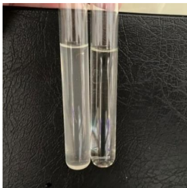
18. ábra: Az EPS-t jelző opálos szín megjelenése a kémcsőben (bal), kontroll minta áttetsző színe (jobb)
