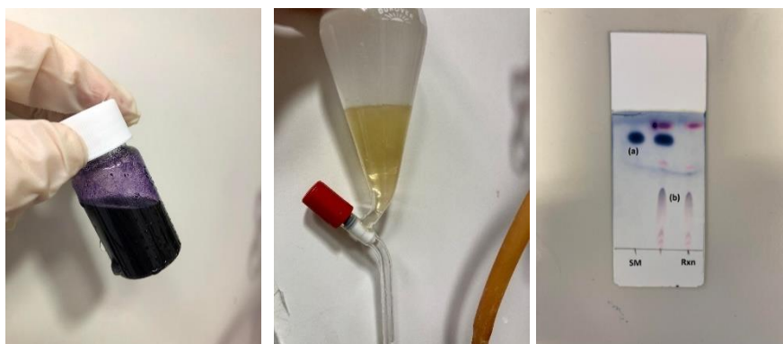
47. ábra. A reakcióelegy jellegzetes lila színe; sárga szín a nátrium-bikarbonáttal való mosás után; a termék jellegzetes megjelenése VRK-n, CAM (Cérium-ammónium-molibdenát) előhívószerral ((a) alkén, (b) tiantréniumsó, SM: kiindulási elegy, Rxn: reakcióelegy) [108]
