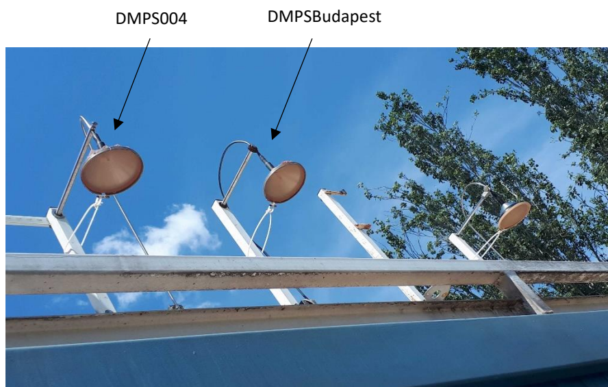
7. ábra: A konténer tetején található mintavevő csövek (inletek)
