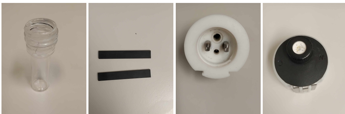
4.2. ábra. A baloldali ábrán az 5 ml-es cella, mellette az elektródként használt grafitlemezek láthatók. A két jobboldali ábrán a cellát és az elektródot rögzítő foglalat látható.
