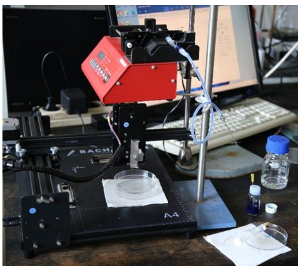
4.4. ábra: A nyomtatáshoz használt Bachin T-A4 Writing-Robot (robotíró), a fecskendőpumpa és a fecskendő együttese
