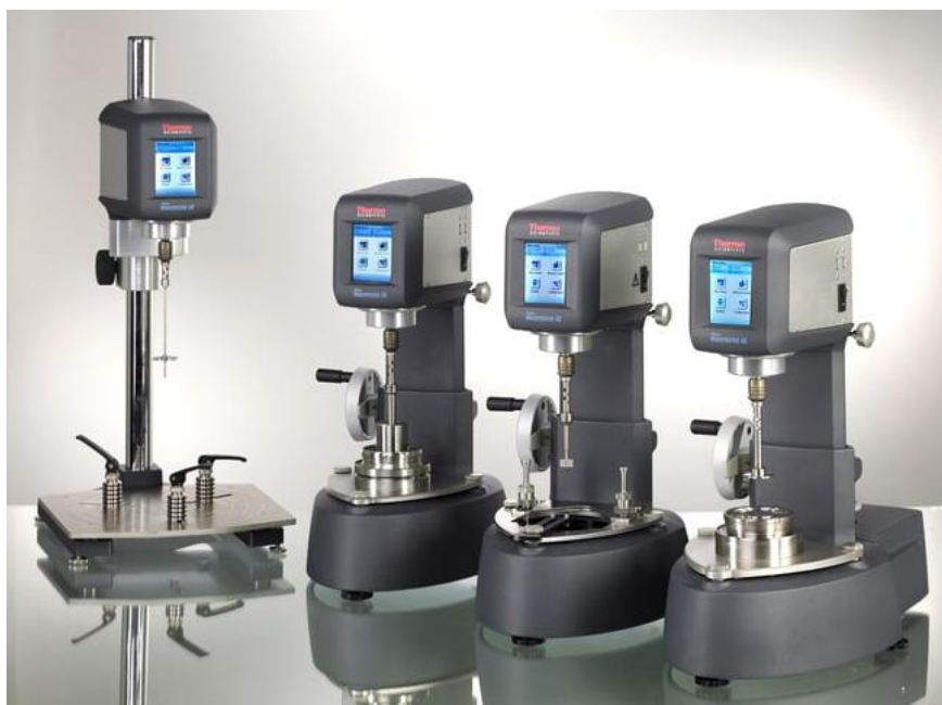
3. ábra: A Haake IQ1 viszkoziméter és felépítési lehetőségei (a jobb szélső a Pénzjegynyomdában használt kialakítás) [7]
