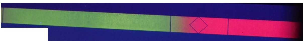
17. ábra: A PJ982 (14%-os pigmentarányú) és a PJ005 festékek 254, illetve 365 nm hullámhosszú UV-sugárzás hatása alatt.
