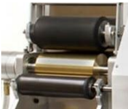
10. ábra: Az Inkomenter –Model 2006U típusú, tack-et mérő gép hengerei [13]
