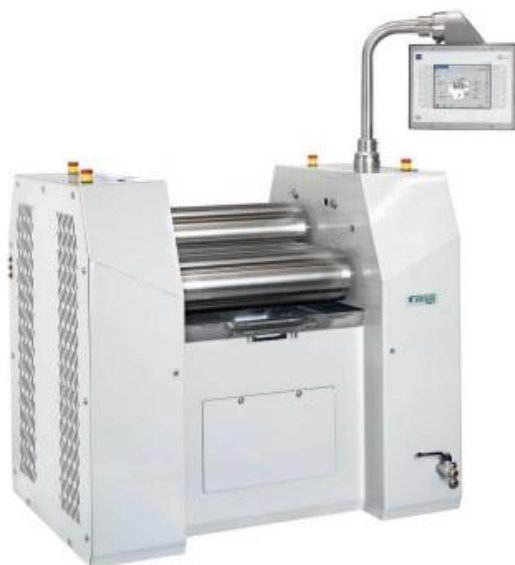
1. ábra: A Buhler cég Trias 300 típusú festékkerő gépe [5]
