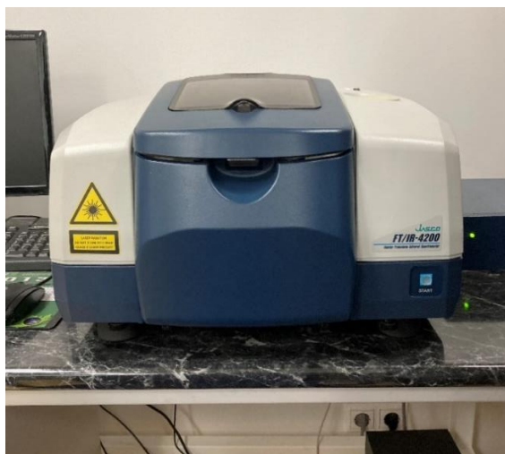
15. ábra Jasco FT-IR 4200 típusú infravörös spektrométer (Szerző saját szerkesztése)
