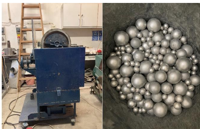
8. ábra Laboratóriumi golyósmalom őrlés közben (bal) és a malom acél őrlőgolyói (jobb) (Szerző saját szerkesztése)
