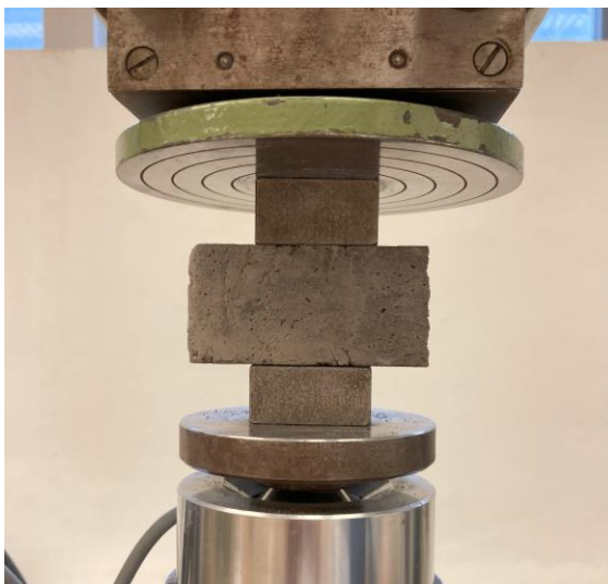
13. ábra Nyomószilárdság vizsgálat a hajlítószilárdság mérés során kettétört próbatest egyik felén (Szerző saját szerkesztése)
