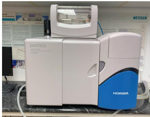
11. ábra HORIBA LA-950V2 típusú lézeres szemcseméret elemző berendezés (Szerző saját szerkesztése)
