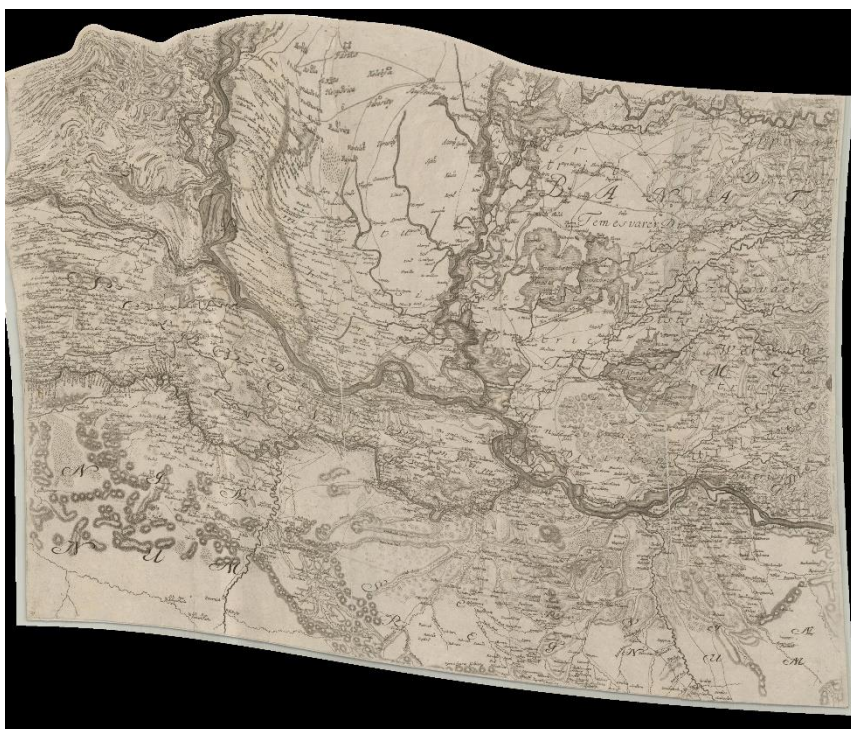
10. ábra A Müller-térkép gumilepedős módszerrel készült georeferált verziója. Ahogy ezt később említtem, ez módszer sok torzítást okoz a képből, viszont adott pontokra illetve térképi elemekre nézve pontos térképet ad
