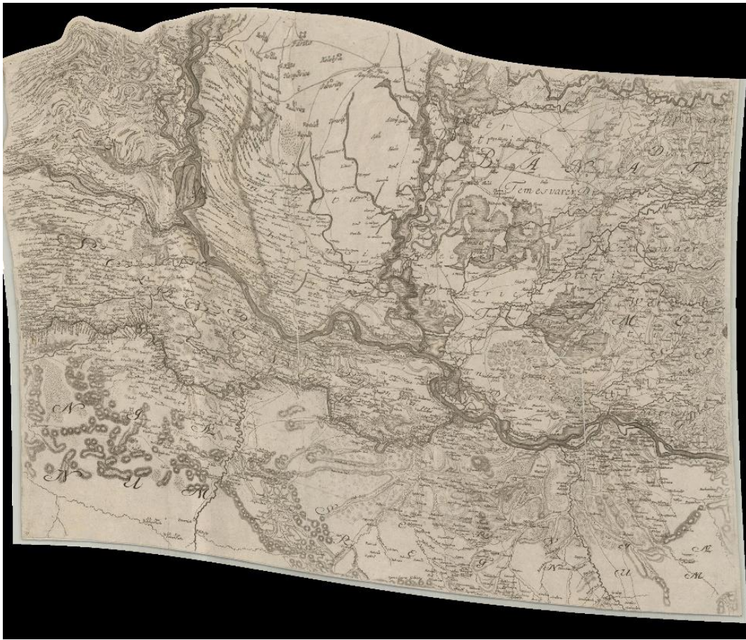
9. ábra. A Müller-térkép gumilepedős módszerrel készült georeferált verziója. Ahogy ezt később említtem, ez módszer sok torzítást okoz a képen, viszont adott pontokra illetve térképi elemekre nézve pontos térképet ad.
