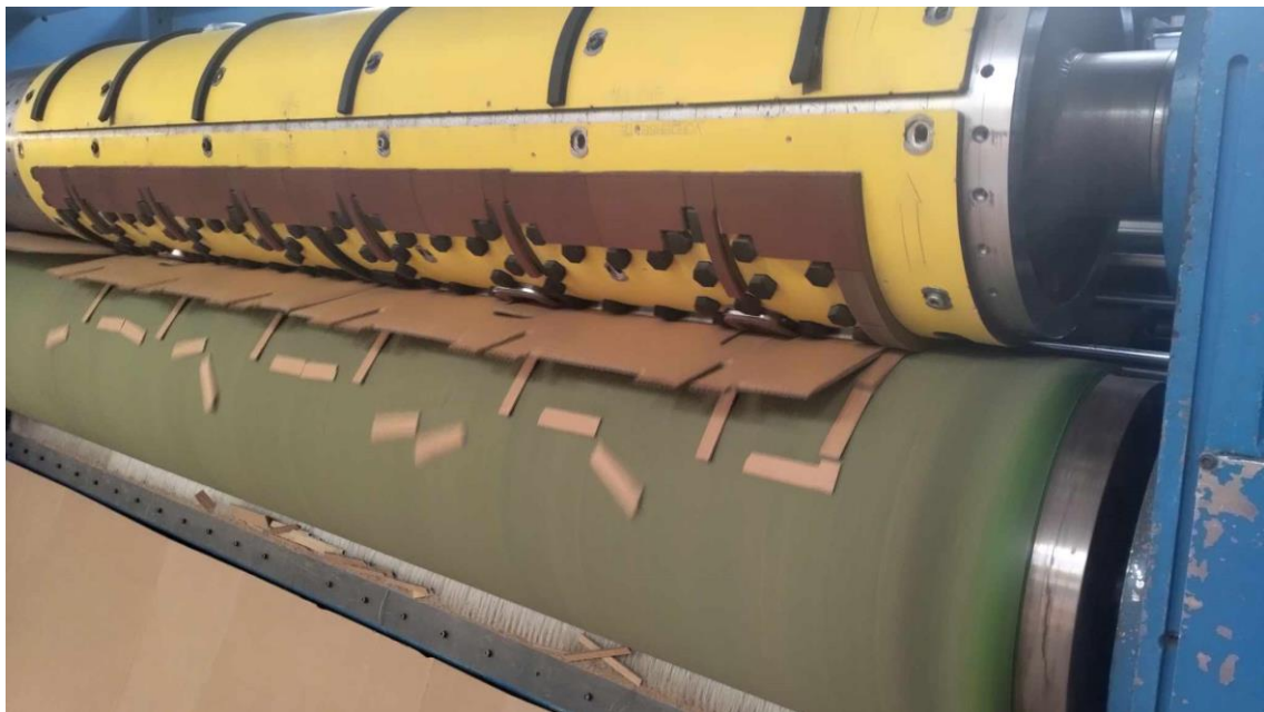
11. ábra: Göpfert típusú rotációs gép működés közben [saját ábra]
