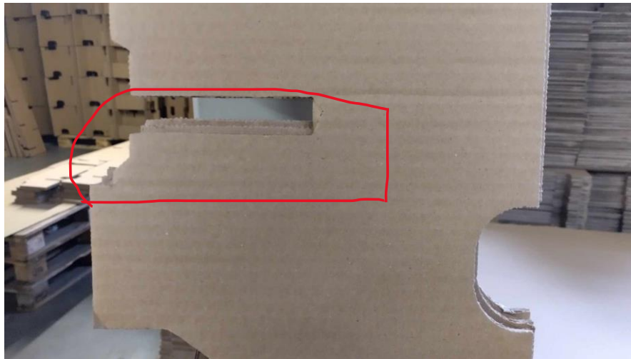
22.ábra Korábbi csomagoláson tapasztalat hiba – a rétegek elcsúszása [saját ábra]
