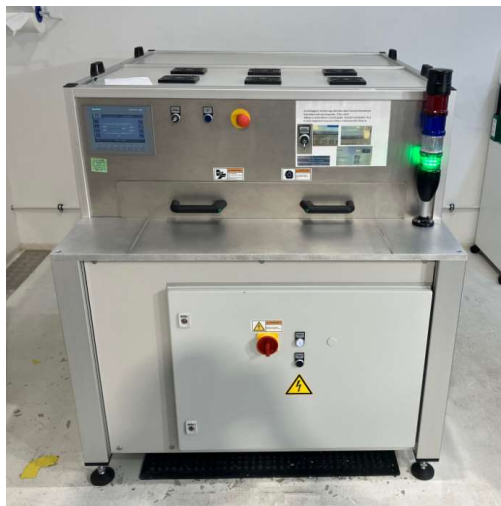
8. Ábra: Műszaki tisztaság eléréséhez alkalmazott tisztítógép
