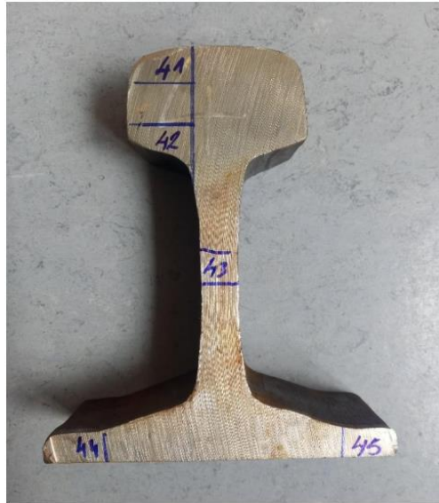
13.sz. ábra. Mintavételezési pontok a metallográfiai vizsgálathoz.
