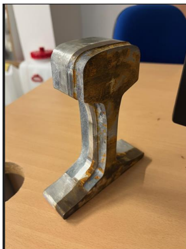
10. sz. ábra. A saválló közbetéttel összehegesztett síndarab
