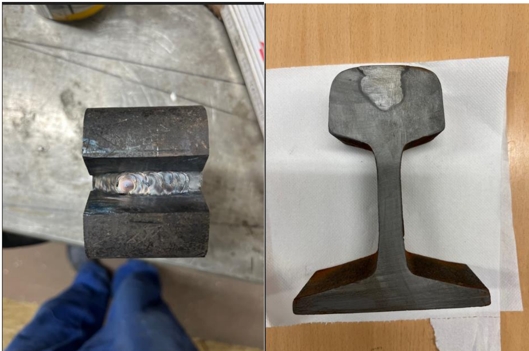
26-27. sz. képek. Egy kép a hegesztésről és az utána keletkezett hőhatásövezetről.
