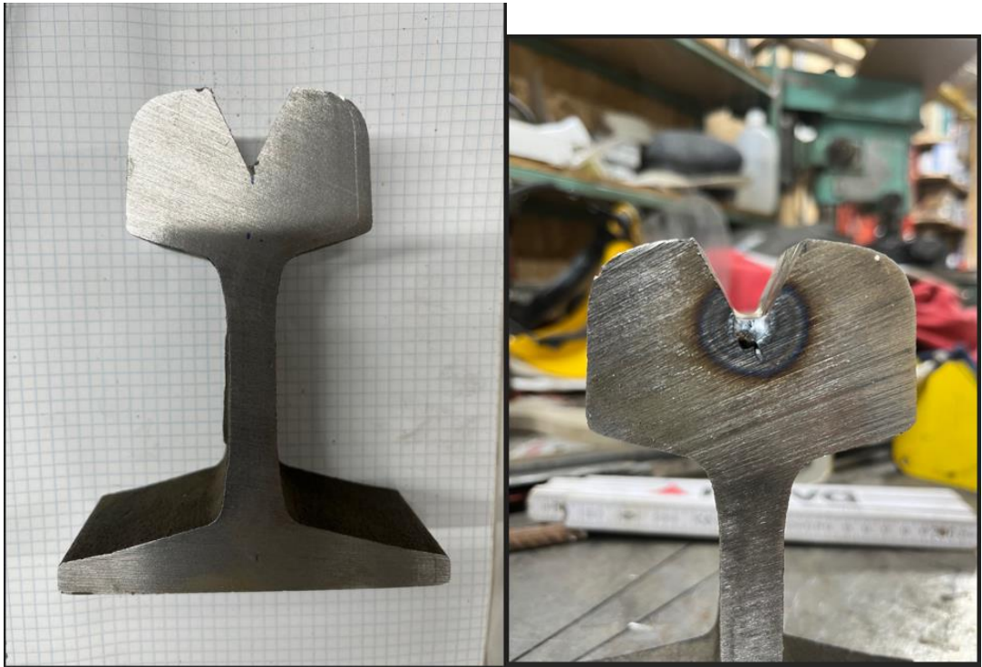
24-25.sz. képek. A bevágásról és az első hegesztési sor alatt maradt beolvadási hiányról.
