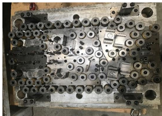
3. ábra Régiszerszám felső rész fejlap+rendszer rugók (saját kép)
