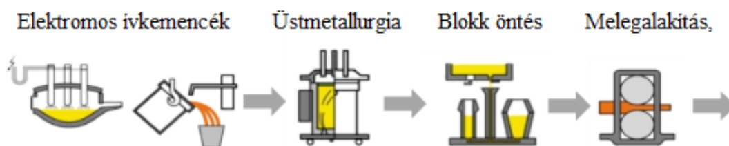
15. ábra K110 gyártási folyamata és felhasználása [9]
