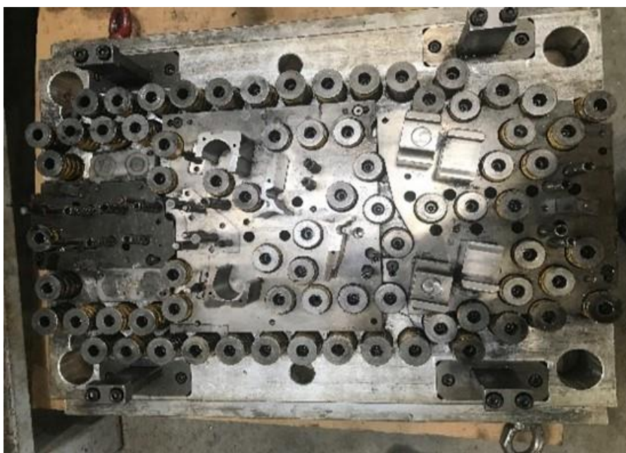
3. ábra Régi szerszám felsőrész fejlap+rendszer rugók (saját kép)
