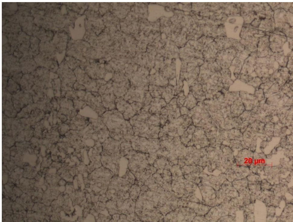
14. ábra Böhler 1.2379 minőségű vágóelem alapanyagáról készített szövetkép 500x nagyítás (saját kép)
