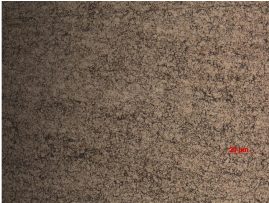
16. ábra Böhler K490 minőségű vágóelem alapanyagáról készített szövetkép 500x nagyítás (saját kép)
