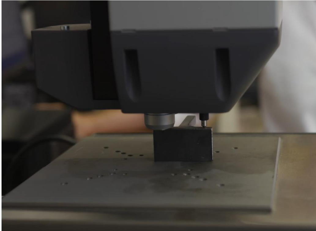
10. ábra A Wilson VH3100-as gép vizsgálat közben
