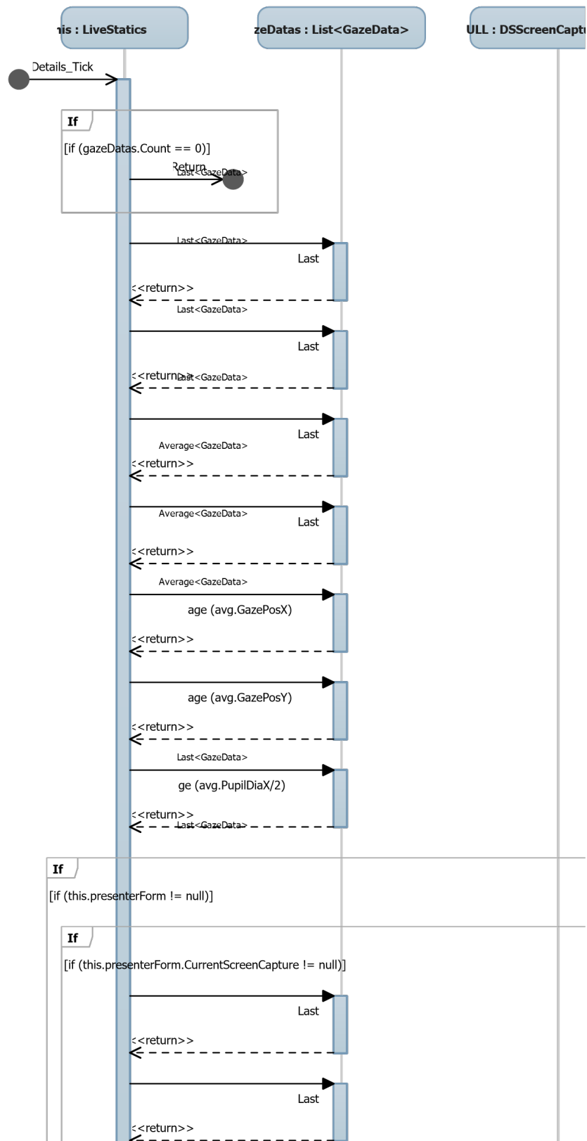
8. ábra: Szekvenciadiagram a szemmozgás követő eszköz adatainak kiolvasásáról. Forrás: Saját készítésű ábra
