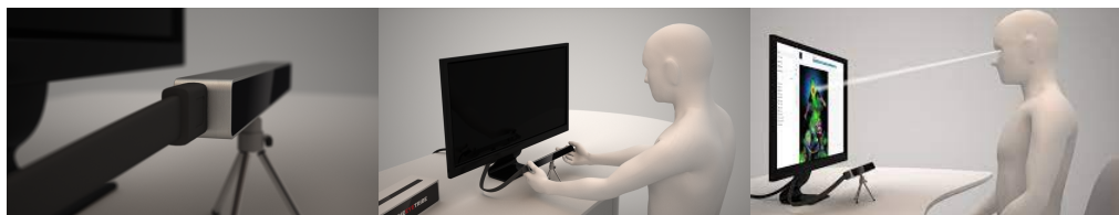
4. ábra: Az Eye Tribe szemmozgáskövető eszköze.
