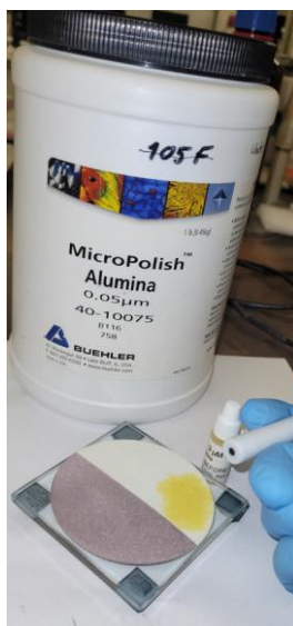
19. ábra: Forgatható korongelektród polírozása.
