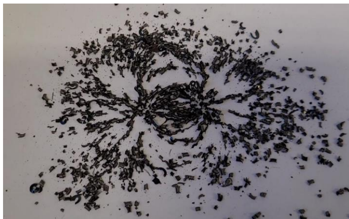
25. ábra: Mágneses indukciós vonalak kirajzolódása öntött vasreszeléssel.
