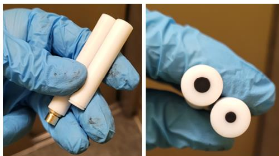
17. ábra: Eredeti (jobb oldali, d=3mm GC), és a saját (bal oldali, d=4mm GC) forgatható korongelektród.
