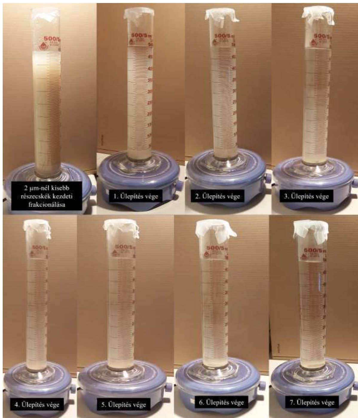
10. ábra: Az 1-2 \mu\text{m} -es részecsketartományú frakció ülepítése
