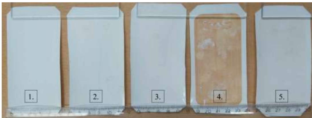
17. ábra: Az elszíneződött membránok (1.-nem használt, 2.-paracetamol szűréséhez használt, 3.-nátrium-klorid szűréséhez használt, 4.-kalcium-klorid szűréséhez használt, 5.-kalciumklorid szűréséhez használt és 10 párosréteggel módosított)
