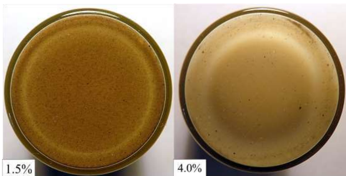
9. ábra: Az 1,5 tömeg%-os és 4 tömeg%-os szuszpenziók üledéke 10 nap elteltével
