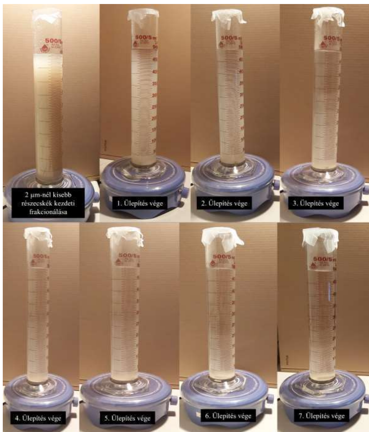
10. ábra: Az 1-2 \mu\text{m} -es részecsketartományú frakció ülepítése
