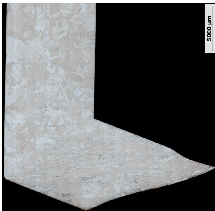
5.4. ábra: A véglap dőlésszöge az átsajtolás második mintáján
