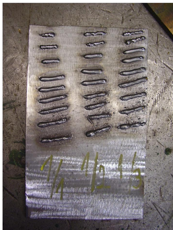
19. ábra. I/1-I/3próba varratok
