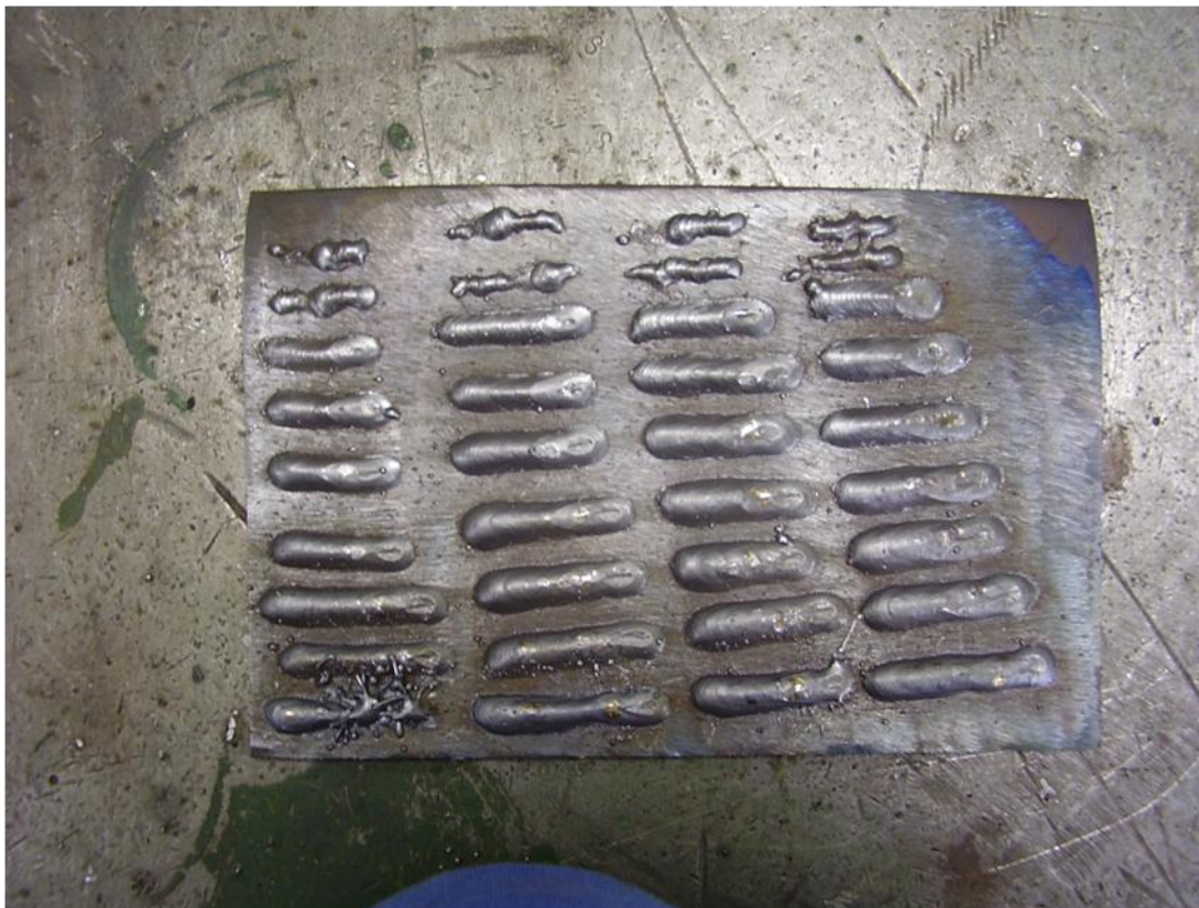
20. ábra. A II/5 - II/8 karakterisztika próbavarratai
