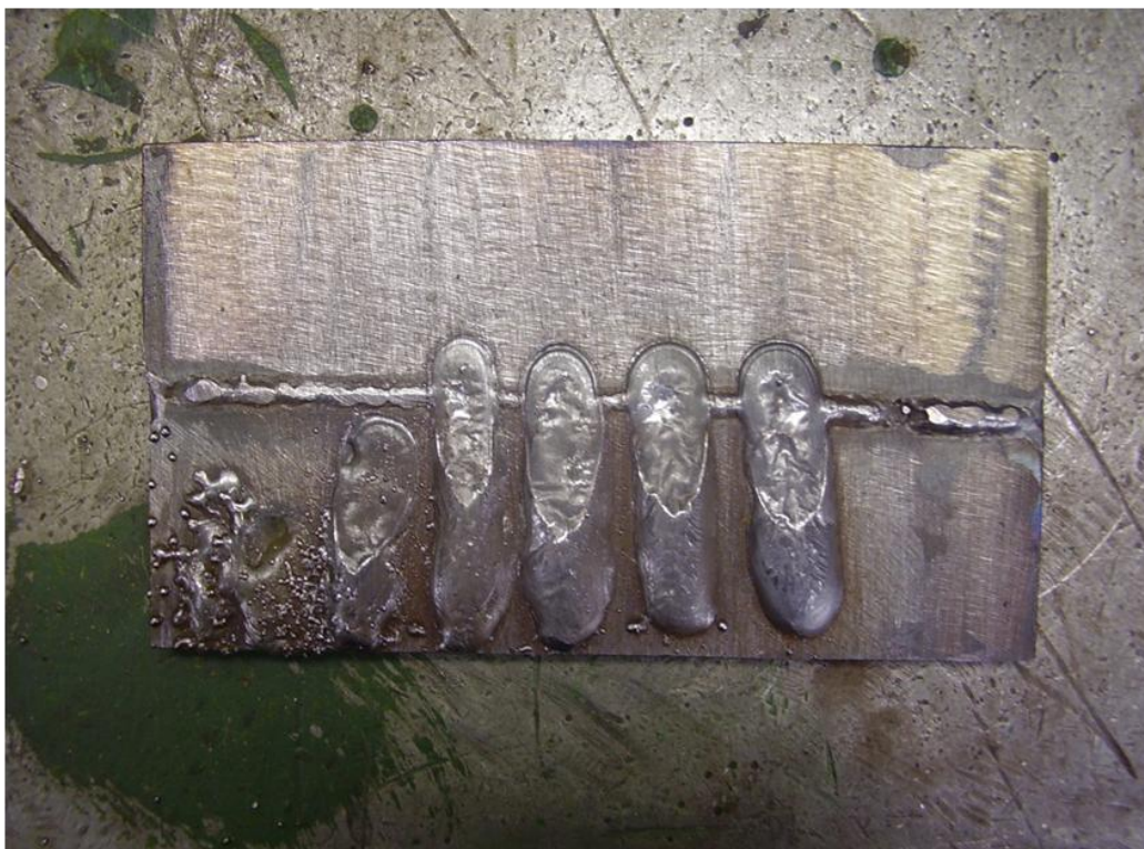
21. ábra. III/11 jelű karakterisztika próbavarratai
