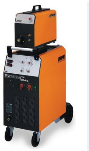
18. ábra. REHM Synergic 504 típusú fagyóelektrodás ívhegesztő gép
