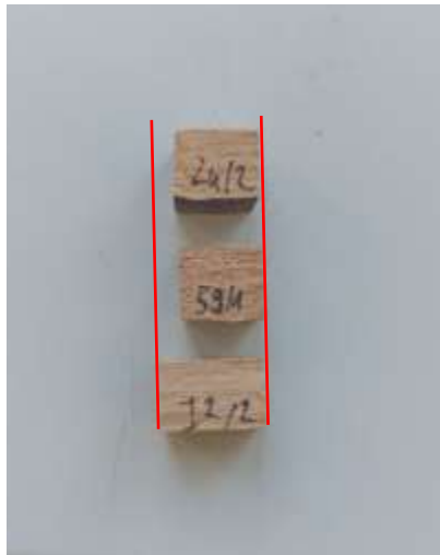
26. ábra: Különböző módokon kezelt próbatestek nyomószilárdság vizsgálat után. Jelölések: 24/2: Tömörített, 12%-os nedvességtartalom; 59/1: Tömörített, abszolút szárazra szárítva, majd 12%-os nedvességtartalomra kondicionálva; 72/2: Kezeletlen, 12%-os nedvességtartalom
