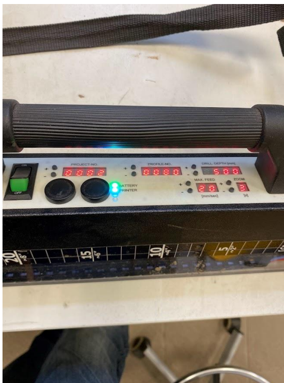
1. ábra Beállítható a projektnek és a fúrásnak a száma, annak a mélysége, előtolása, és nagyítása.
