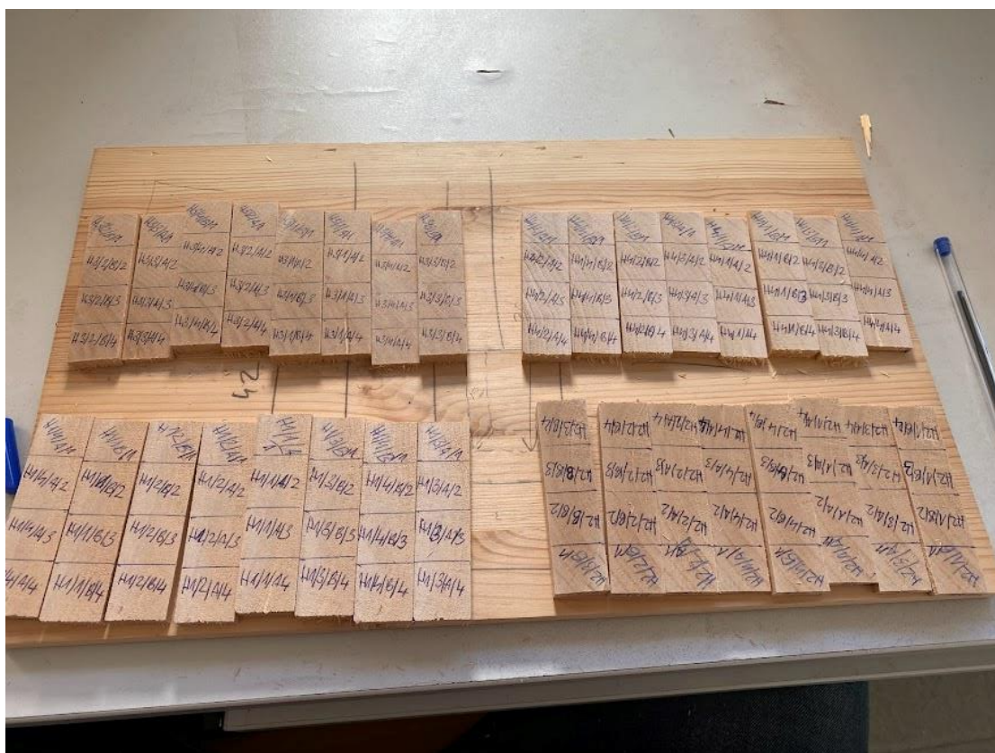
17. ábra Gervágóval felvágott minták, felrajzolás után, hasítás előtt.
