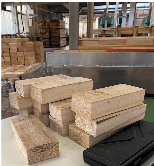
6. ábra Császárfán erősen kivehető a szijács és geszt találkozás.
