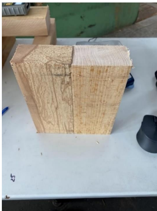
3. ábra Különböző stádiumú károsodott frízek.
