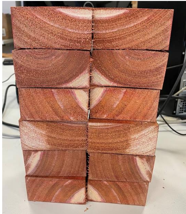
32. ábra Telítési hibák kirajzolódása hat félbevágott frízen.
