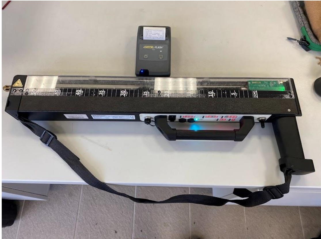
13. ábra Rezisztográf készülék a hozzá tartozó nyomtató egységgel.
