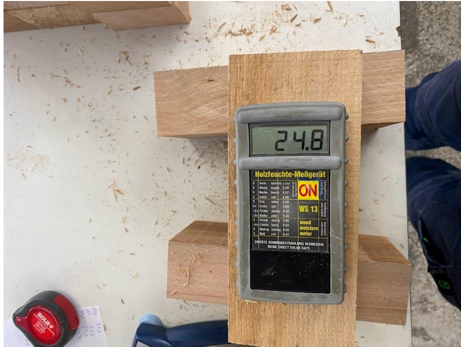
10. ábra Az érintőszondán megfelelő sűrűség beállítása után lehet csak mérni.
