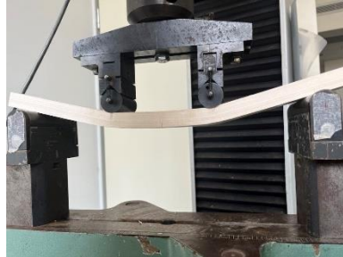
12. ábra mérési elrendezésem megfigyelhető az Instron 4208 univerzális anyagvizsgáló gépben
