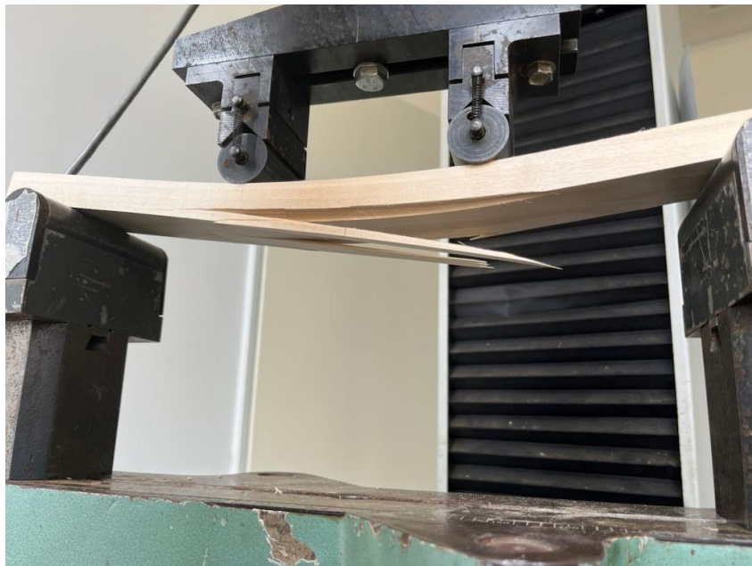
14. ábra rostkifutás a tönkrement próbatesten
