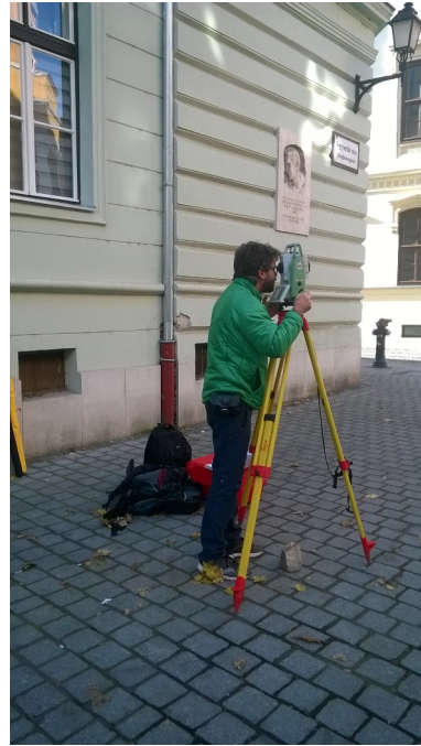
30. Ábra: Mérés mérőállomással
