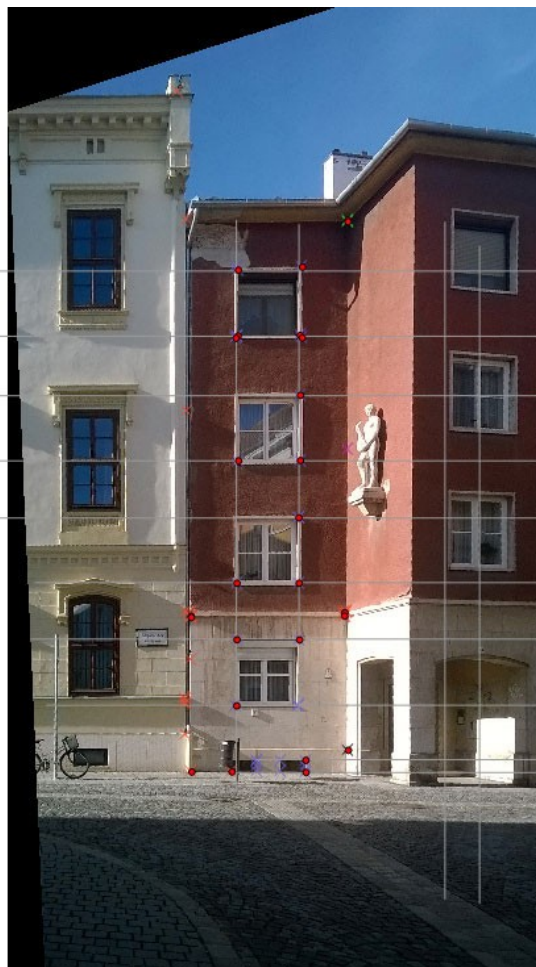
6. Ábra: Eredeti fénykép és projektív algoritmussal georeferált homlokzat-kép
