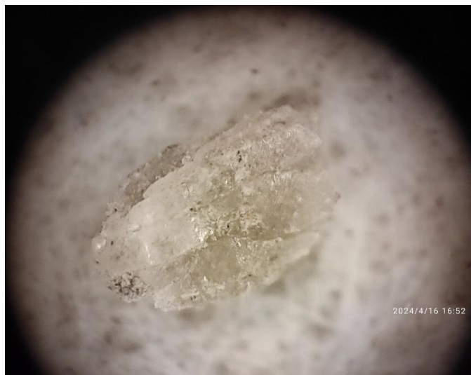
34. ábra - Hosszabban elnyúlt réteges kalcit-kristály
