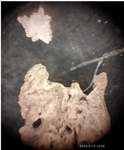
23. ábra - Víztiszta kalcit-kristály eltávolítása az oldási maradékból
