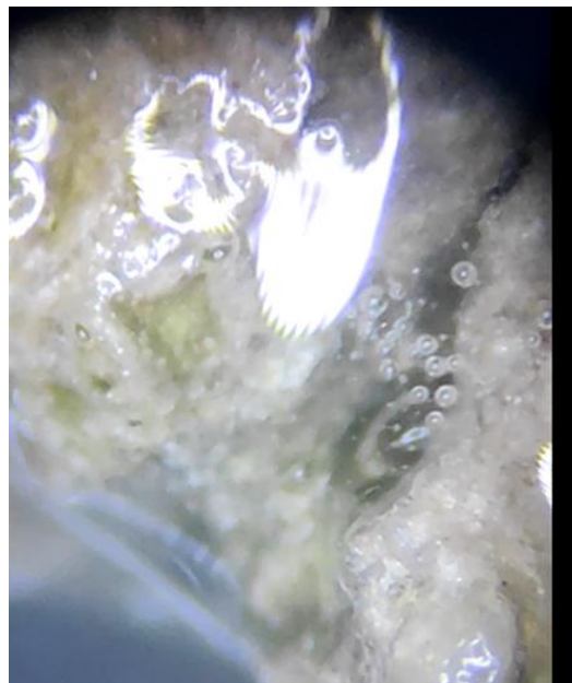
24. ábra - Az oldási maradék sósav hatására pezsegni kezd
