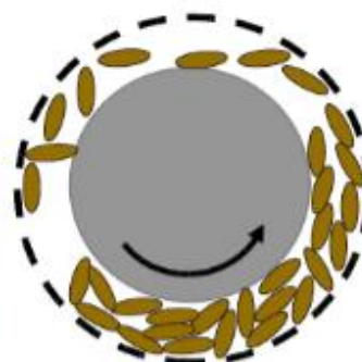
3. ábra Satake laboratóriumi tárcsás hántoló berendezés (saját fotó)
